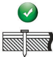
Рис. 2 Пример правильной забивки гвоздей при монтаже продукции.
